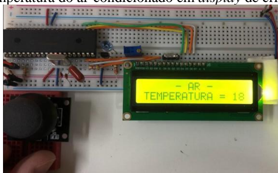
Figura 4 - Menu da temperatura do ar-condicionado em display de cristal líquido.
